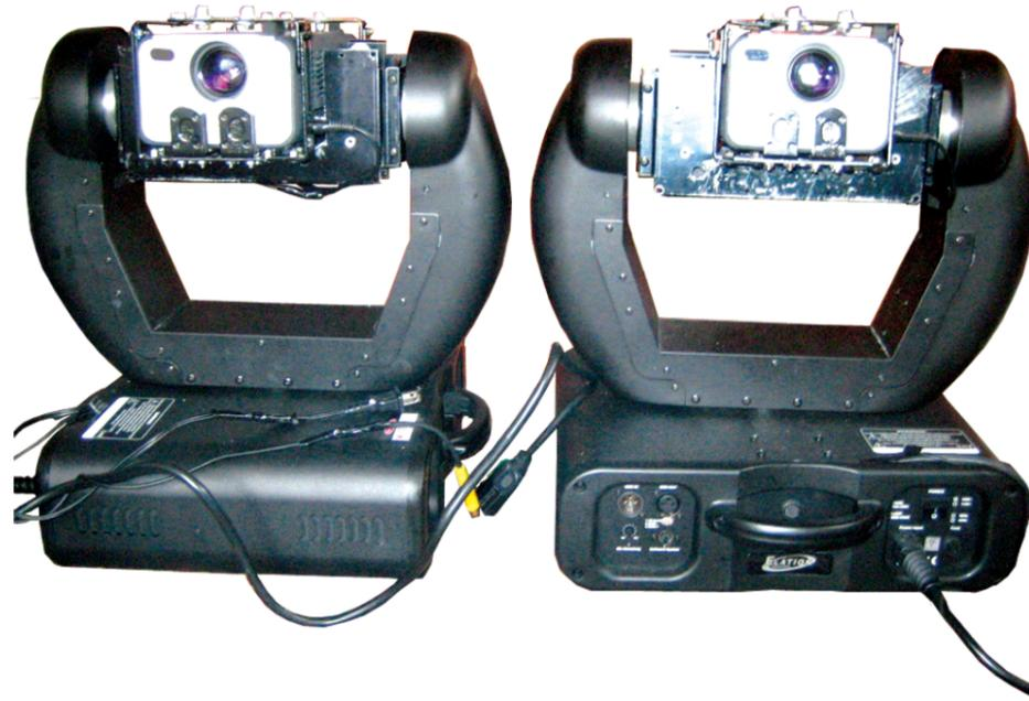
Das ist ACTIVE VISION. Mit dieser Maschine kann man den Projektor bewegen. Damit kann man das Bild von verschiedenen Winkeln projizieren und mit einem Computer steuern. (Horizontaler Radius  $\leftrightarrow 540^\circ$  Vertikaler Radius  $\updownarrow 270^\circ$ ) Sie benötigt DMX-Signal, Videosignal und einen PC (DMX-signal hat 512kanal). Ein einziger Projektor verwendet 15 Kanäle und die ganze Machinerie, bestehend aus 2 Projektoren, 30 Kanäle.
